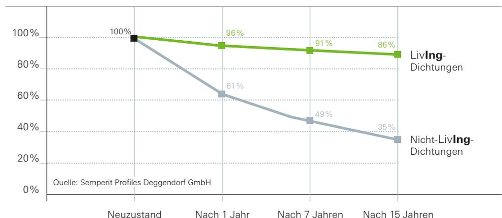
\*Verhalten einer Dichtung bei wiederkehrendem Zusammendrücken, z. B. Öffnen und Schließen des Fensters. Optimal ist eine Rückverformung in die Ausgangskontur. Denn nur diese gewährleistet eine dauerhaft hohe Dichtwirkung.
